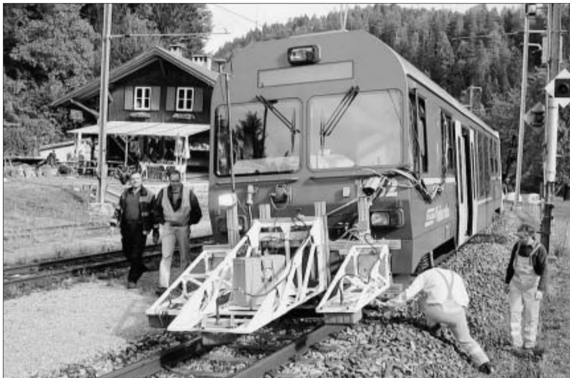
Der Messzug mit den «Georadar»-Antennen unterwegs in der Surselva.
